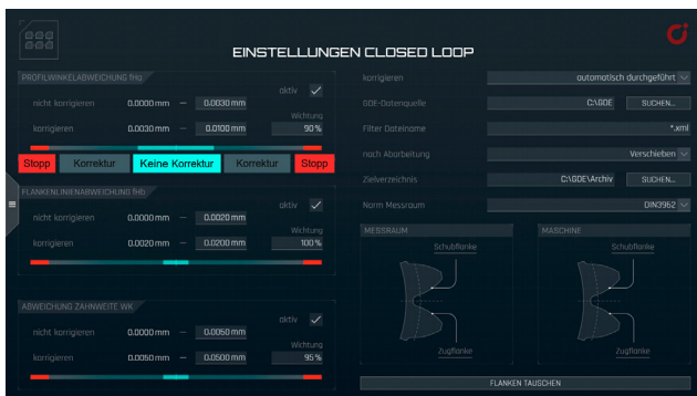
Bild 1: Closed Loop-Einstellungen auf der Bedienoberfläche © KAPP NILES
